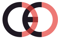
Falsche CE-Kennzeichnung (zu dicht)
