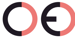
Falsche CE-Kennzeichnung (zu großer Zwischenraum)
